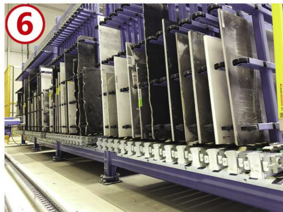
6 - RECUPERO Sistema automatico di accumulo/recupero con 60 slot. Ogni slot può contenere fino a 5 pezzi residui in linea. Dimensione minima del pezzi residui 1300 mm (L) x 500 mm (H). Pezzi gestiti automaticamente dal ribaltatore. 6 - RESTORE Automatic buffer/Restore system composed of 60 slots. Each slot can host up to 5 remnants in-line. Minimum dimension of remnant (w) 1300mm x (h) 500mm. Pieces managed automatically by the tilting table.
