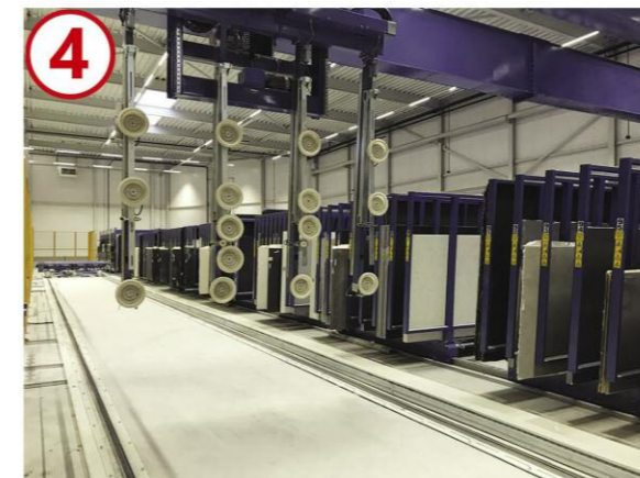
4 - CARROPONTE AUTOMATICO Corsa/passo di 24 m, opera sotto le gru manuali. Capacità: 800 kg. per singola lastra. Sistema brevettato per posizionare le lastre senza danneggiarle. Rotazione 270°. Dimensione min. lastre 1250 mm (L) x 950 mm (H). 4 - AUTOMATIC GANTRY CRANE SYSTEM 24 mt. span/gauge running under the manual cranes. Capacity: 800 kg. single slab. Patented system to place slabs without damaging them. Rotation 270°. Min slab size (w)1250mm x (h)950mm.
