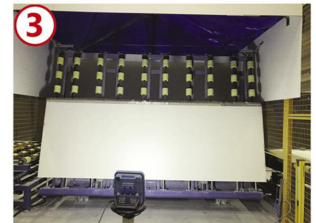
3 - AREA DI CONTROLLO QUALITÀ Ribaltatore automatico con videocamera HD. Area di controllo qualità protetta da sensori di sicurezza. Connessione al software per la gestione delle scorte. 3 - QUALITY CONTROL AREA Automatic tilting table with HD camera. Quality control area protected by safety sensors. Software connection with the stock management.
